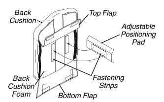
FIGURE 3 - INSTALLING/REMVOING ADJUSTABLE POSITIONING PAD (UNIBACK ONLY)
